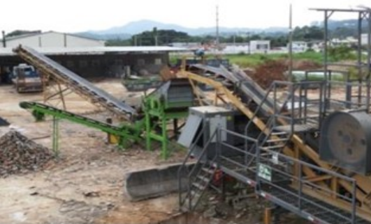
EQUIPAMENTO PARA BRITAGEM DE ENTULHO DA CONSTRUÇÃO CIVIL E A SEPARAÇÃO POR GRANULOMETRIA ATRAVÉS DE PENEIRAS
